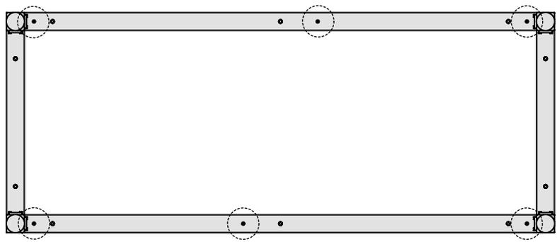
**Nota:** Se deben colocar los Tornillos M6 en los hoyos donde pasan libremente a través del Marco para atornillarse a la rosca de la cubierta en la posición que se muestra en la imagen.
