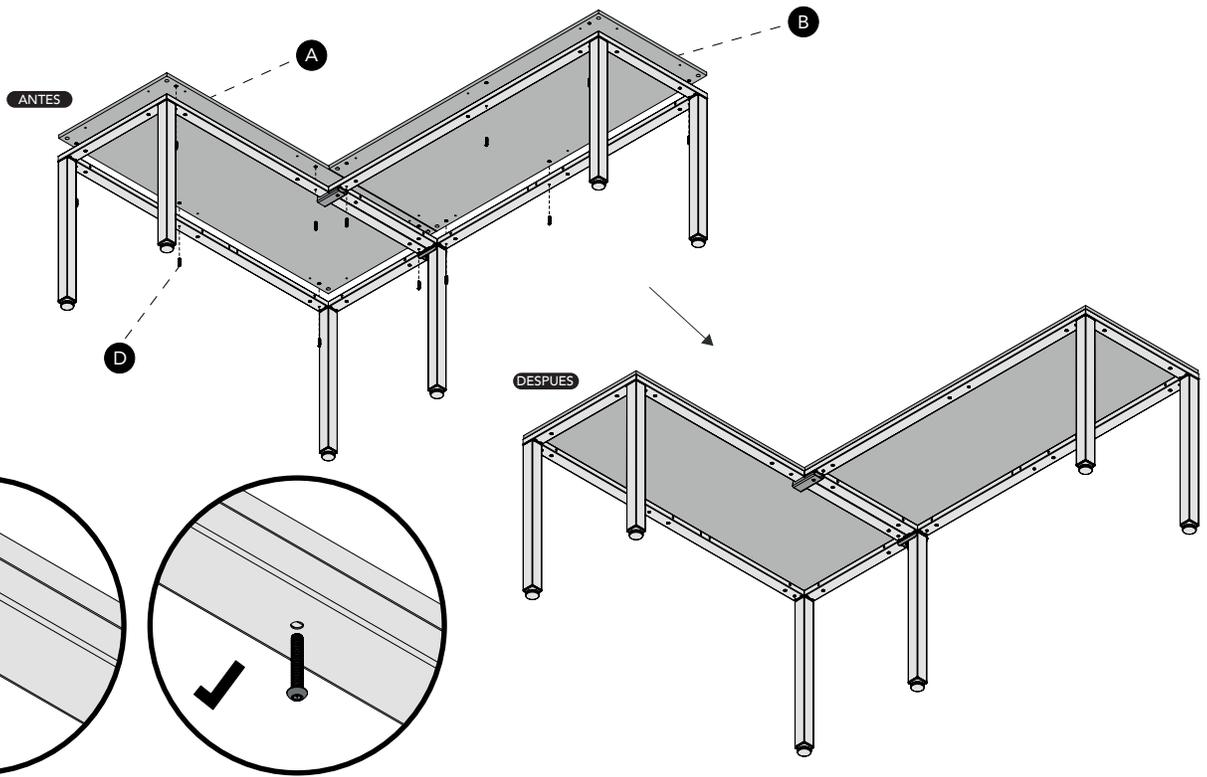
**Nota:** Colocar las 2 Cubiertas sobre sus respectivos marcos. Colocar (\*6) Tornillos M6 a través de cada Marco para fijar a la cubierta.
